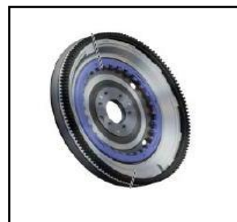
C9) Vista del interior del volante motor Fly Wheel inner view
