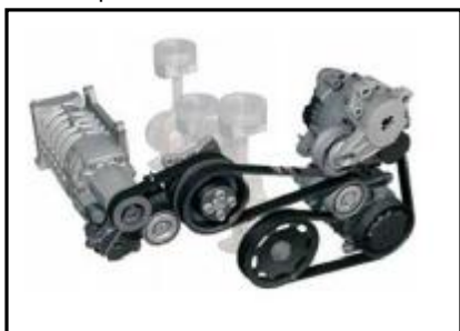
C8) Esquema de la traccion del compresor V. V Compressor traction scheme.
