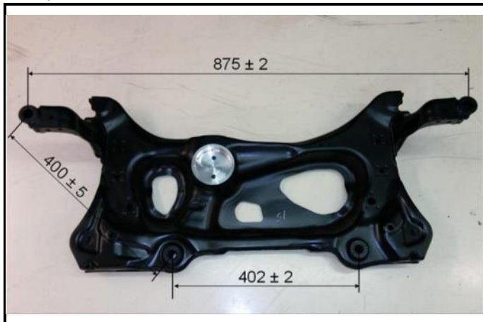
G2-1) Subframe dismounted
