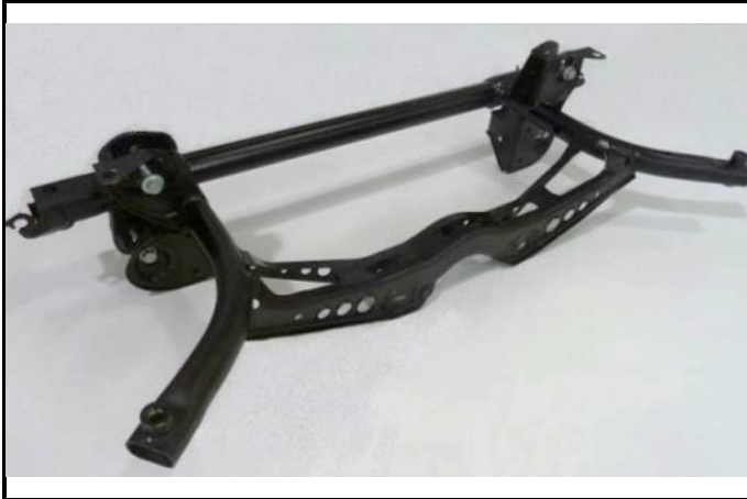
H2-1) Subframe dismounted
