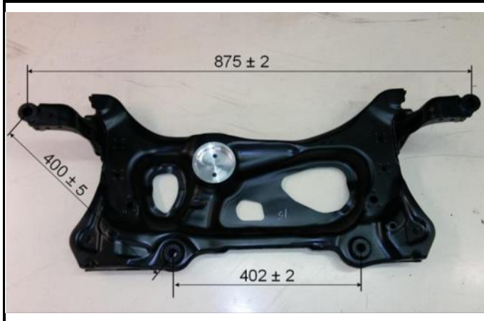
G2-1) Subframe dismounted
